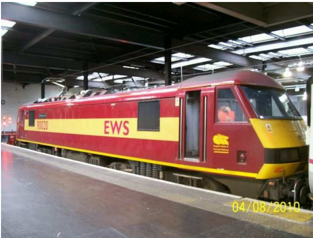
(sin.) DB SCHENKER – (con logo EWS), locomotore 25kV ca, class 90, LONDON EUSTON, convoglio notturno CALEDONIAN SLEEPER proveniente dalla Scozia. EWS (ora DB Schenker) è dedicata al trasporto merci, ma affitta i mezzi di trazione alle altre società per i pochi convogli che devono essere trainati e per cui queste non hanno locomotive. Notare il “traghetttore” in cabina che sta aspettando, non so se di far uscire il treno intero o solo il locomotore. La non necessità di locomotori da treno, implica la stessa mancanza di locomotori di manovra che infatti non ho visto. (des.) carrozze del Caledonian Sleeper.
