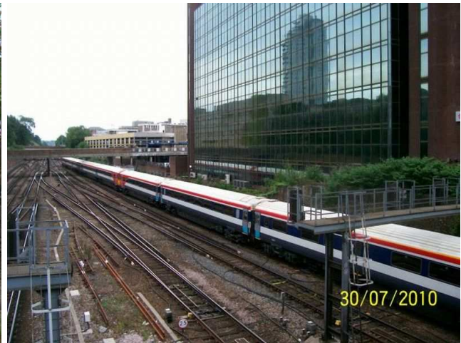
(sin.) FIRST GREAT WESTERN , composizione bloccata di 2 automotrici DMU class 165, a SLOUGH per WINDSOR. Le due automotrici sono "complementari": una con servizio e posto per disabili, l'altra con spazio per biciclette e bagagli ingombranti. (des.) SOUTHERN GATWICH EXPRESS , doppia composizione bloccata di EMU a 5 casse, class 442, CROYDON.
