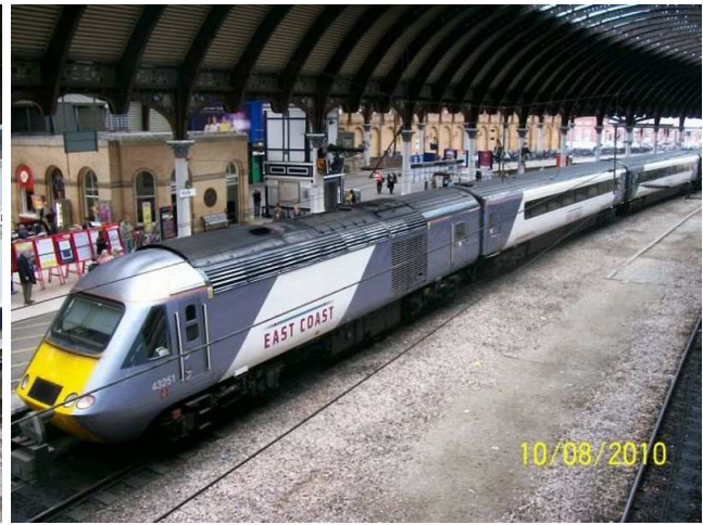
(sin.) GRAND CENTRAL , composizione bloccata 5 automotrici DMU class 180, YORK. (des.) EAST COAST , composizione bloccata con 2 locomotive diesel class 43 HST, a YORK per LONDON KING'S CROSS. Il convoglio era anche definito IC125.
