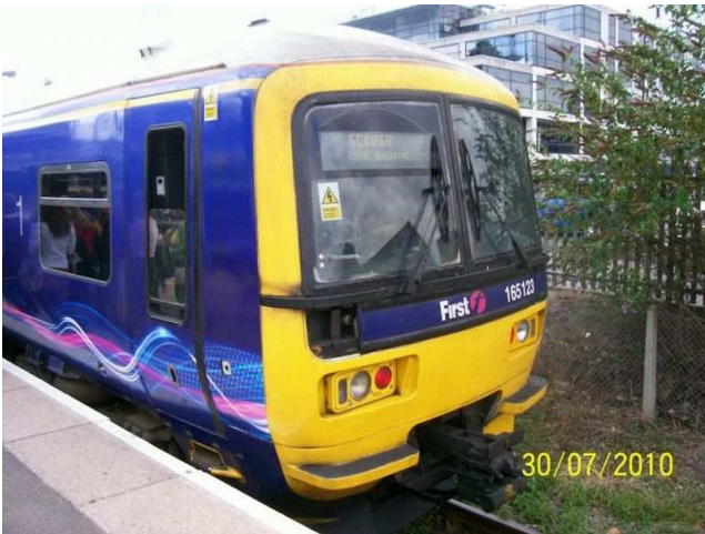
(sin.) FIRST GREAT WESTERN , composizione bloccata di 2 automotrici DMU class 165, a SLOUGH per WINDSOR. Le due automotrici sono "complementari": una con servizio e posto per disabili, l'altra con spazio per biciclette e bagagli ingombranti. (des.) SOUTHERN GATWICH EXPRESS , doppia composizione bloccata di EMU a 5 casse, class 442, CROYDON.
