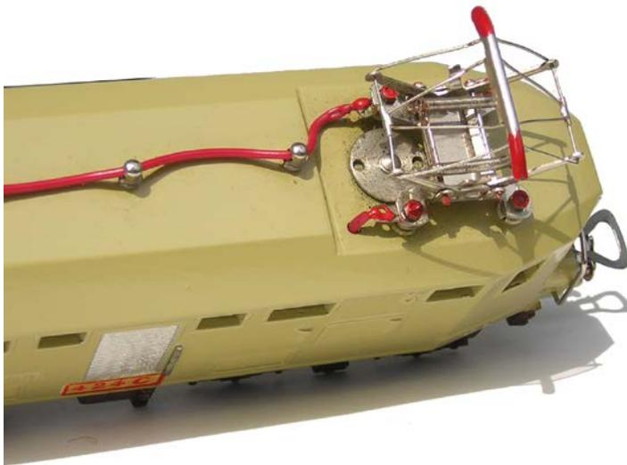
**Altri particolari.** Nuovo sistema di fissaggio del carrello mediante avvvitamento del perno a una piastra circolare. Il nuovo pantografo, è più realistico, provvisto di sistema di chiusura più pratico ed è spinto da due mollette elicoidali.
