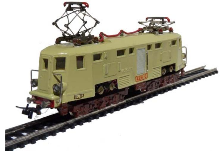
**Magneti permanenti.** I nuovi motori per C/C mostrano in evidenza la sporgenza dei magneti ad anello circolare in luogo dello statore a ferro di cavallo. Notare i ganci ora, ancorati direttamente al carrello invece che al sottocassa. Respingenti conici e assotigliati. Un nuovo accessorio è applicato ad uno dei carrelli: si tratta di un blocchetto isolante con il rudimentale sistema per scambiare l'alimentazione dal binario ai pantografi spostano una piccola vite da un foro a quello attiguo.
