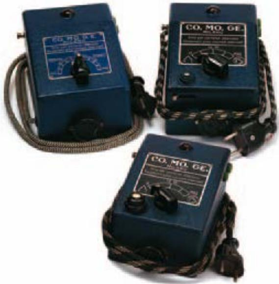
*Successivi..* fino al 1955/56 circa, 15Watt in cassa metallica solitamente blu con variatore graduato, inversione mediante manopola o levetta, successivamente direttamente dalla manopola (primo a sx).
