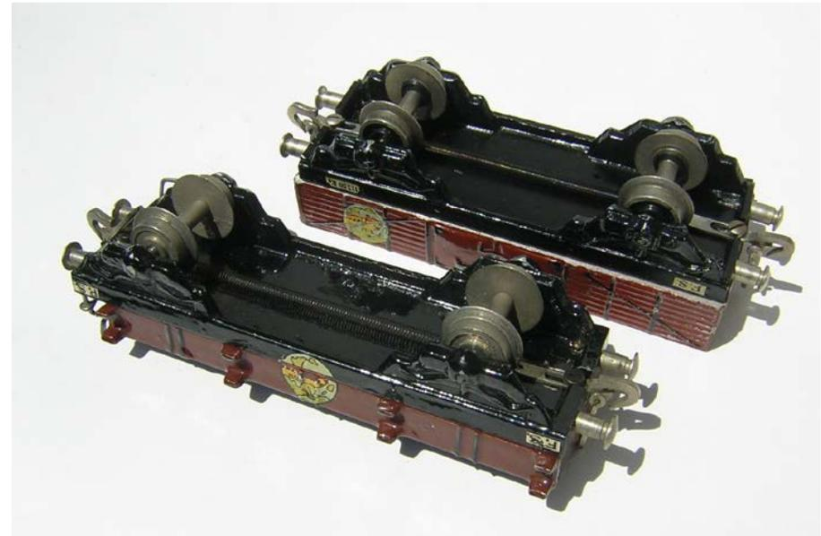
**Assi senza e con isolamento.** I carri abbinati alle primissime produzioni del '46 con 424 che invertiva automaticamente solo dalla linea aerea, non avevano gli assali isolati (carro in primopiano con ruote senza gomma isolante, presente invece nell'altro carro).
