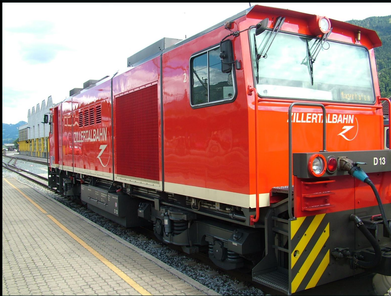
Denominazione D 13 Unità 4 Anno 2004 Velocità km/h 70 Rodiggio B'B' Potenza kW 520
