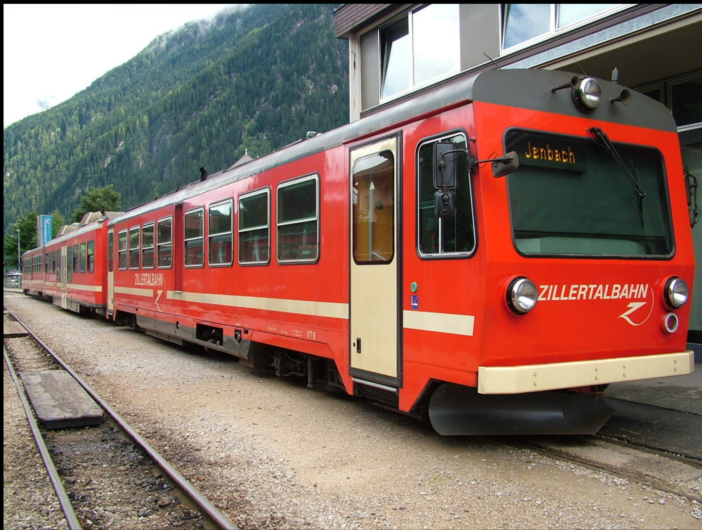
Automotrice della classe VT al capolinea Nord Totale 6 macchine (4 1985 + 2 1998) kW 250 64 posti a sedere
