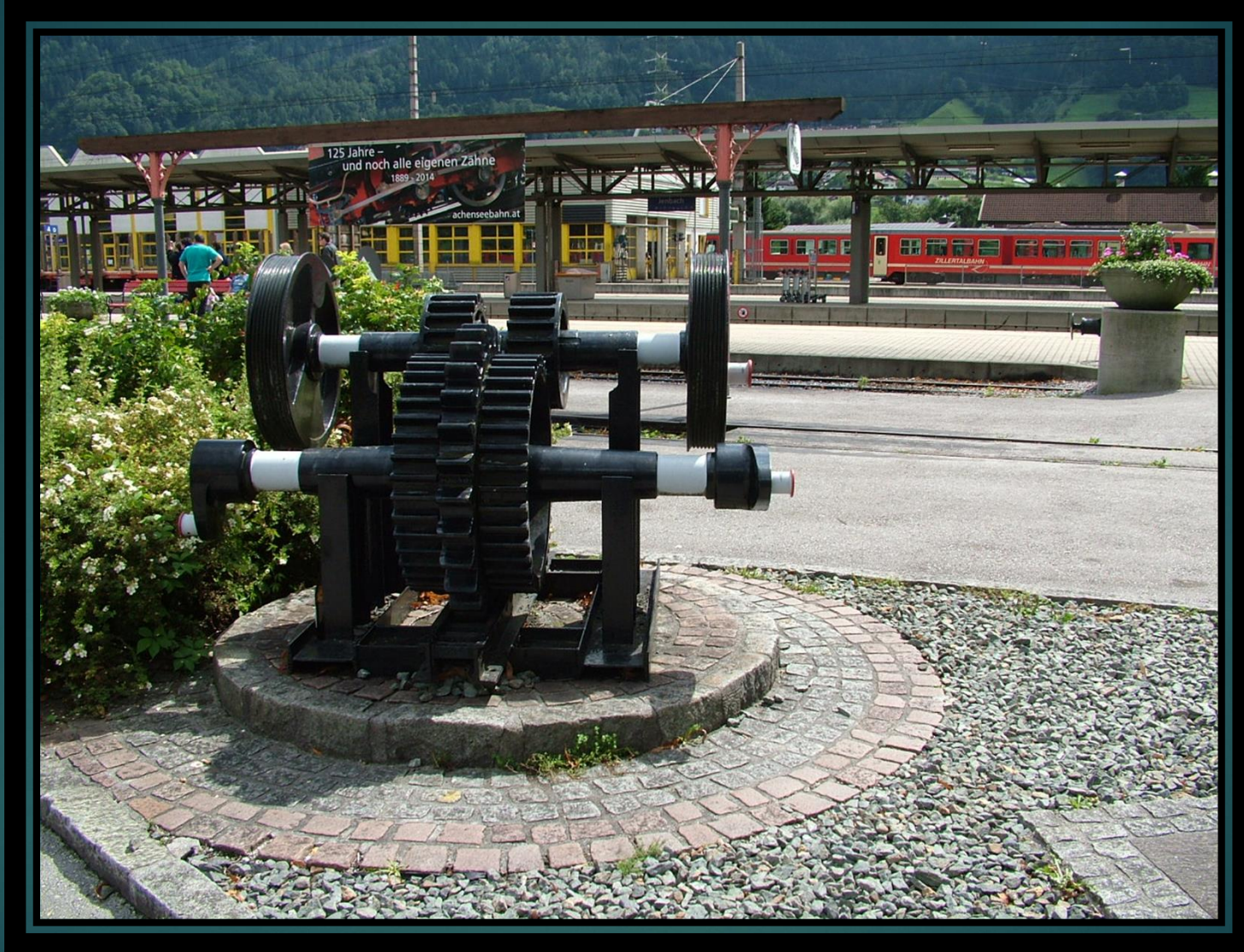
A Jenbach presso la banchina di partenza, si esemplifica il sistema Riggenbach
