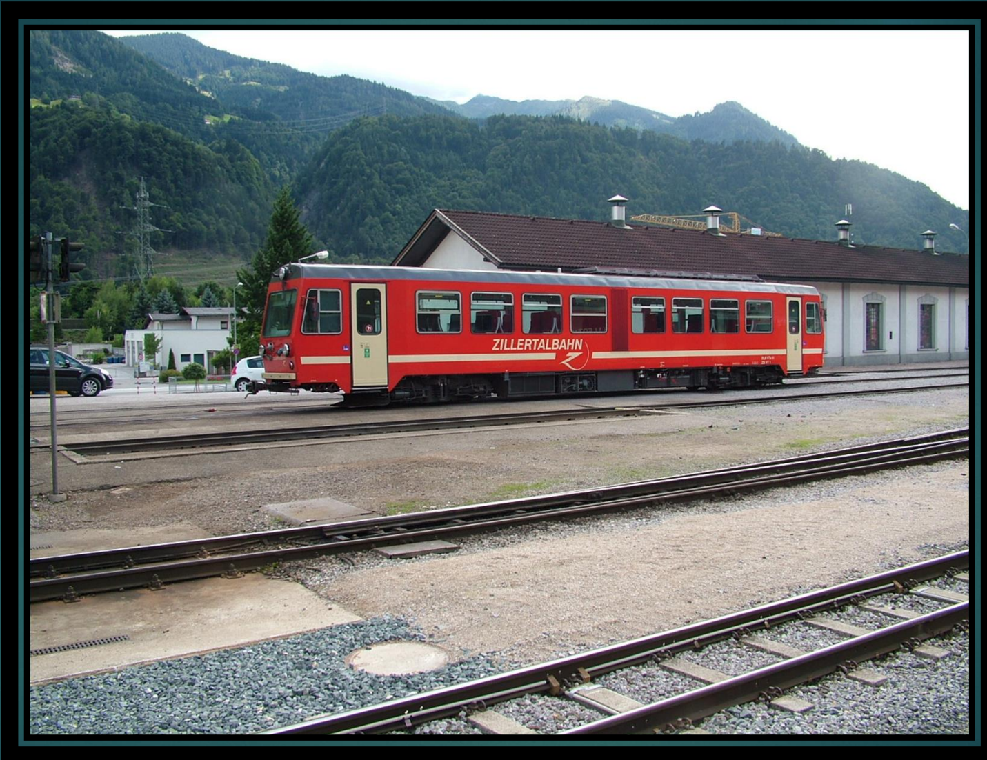
Automotrice Unità unica Matricola VT 1 Velocità 70 km/h Anno 1986 Potenza kW 235 Posti a sedere 64
