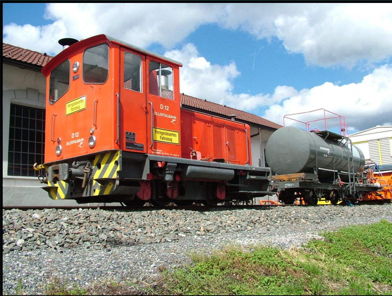
Locomotore da manovra matricola D12 Risale al 1960 Acquistato di seconda mano negli anni '80 Potenza 104 kW
