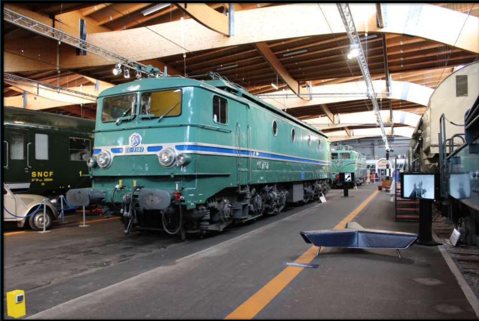
Prodotta dall'Alstom a partire dal 1952, si distinse per la totale aderenza delle ruote che le conferiva una grande potenza. Alimentazione a 1,5 kV a corrente continua.
